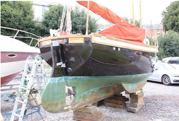
Mayfly Corsaire long keel with bilge fins
